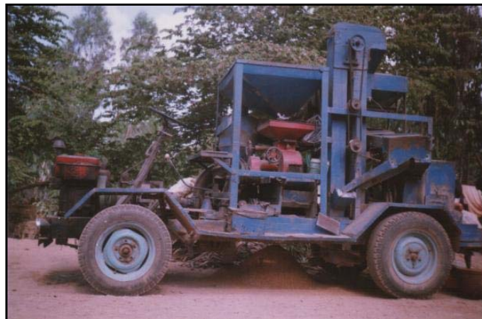
Rizerie mobile (CCIT, Vietnam) nettoyeuse, décortiqueuse, polisseuse, moteur thermique
