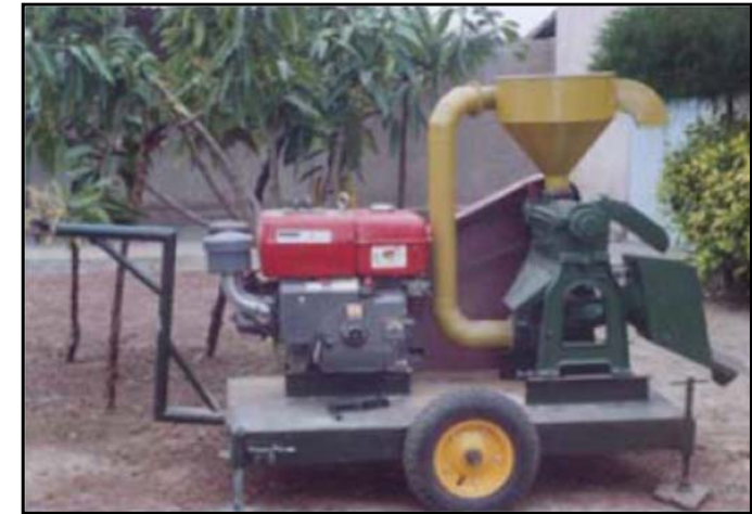
Unité mobile de décortiquage (Véco-Vietnam) Décortiqueuse, groupe électrogène
