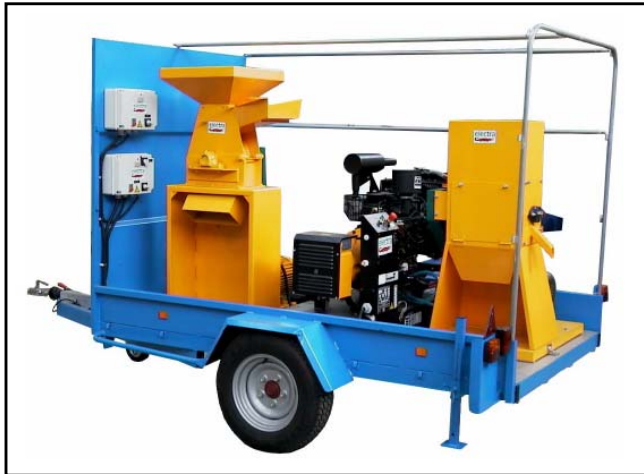
Unité mobile de broyage/décortiquage (Electra) Broyeur, décortiqueuse, groupe électrogène
